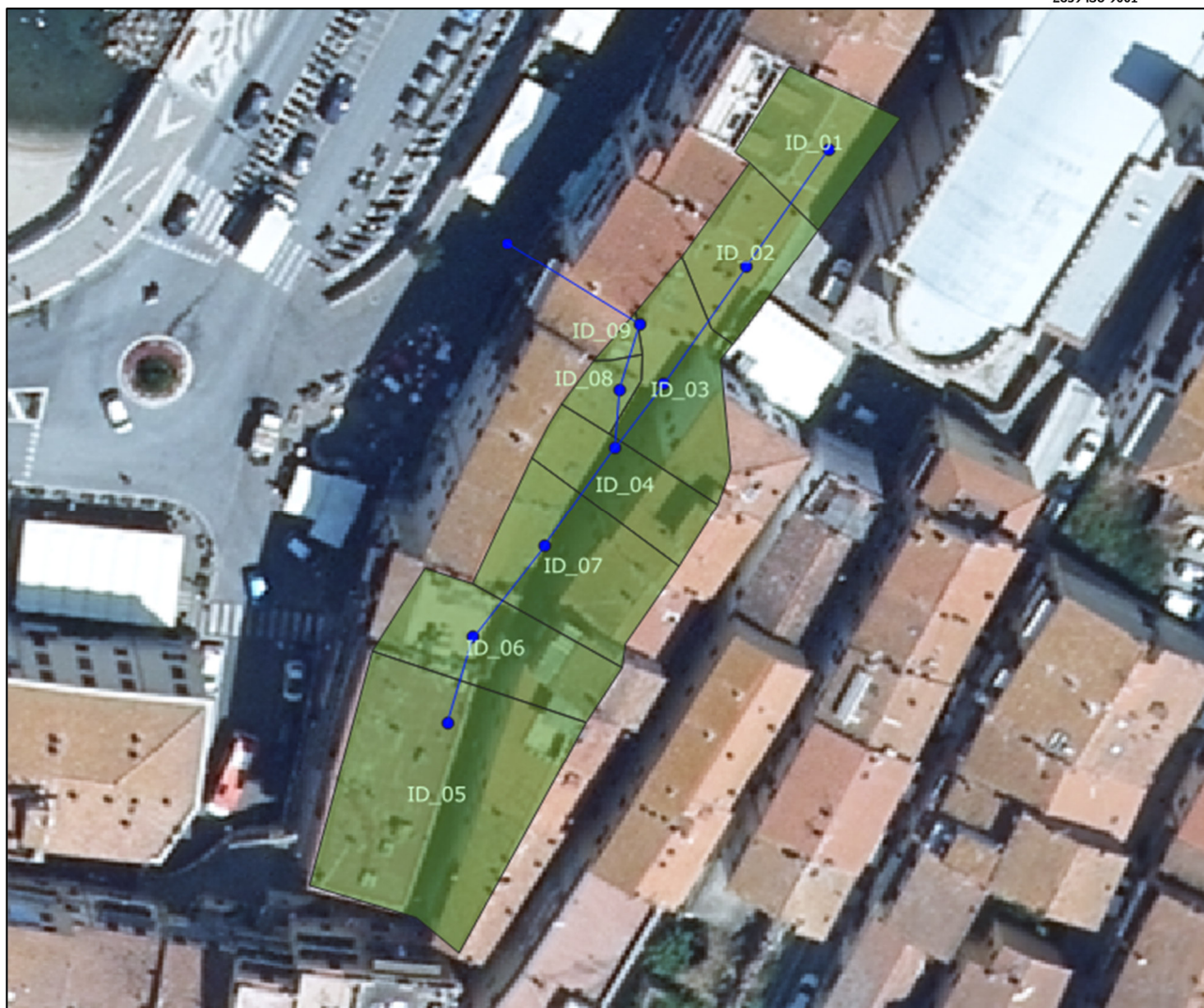
Figura 4: Planimetria di progetto rete di drenaggio acque meteoriche con il riferimento dei sottobacini generati tramite software InfoWorks ICM.
